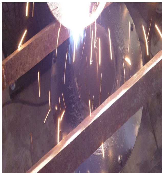
Рис. 8. Фото удаления вредных веществ при втором технологическом этапе раскроя заготовки (вид сверху)
