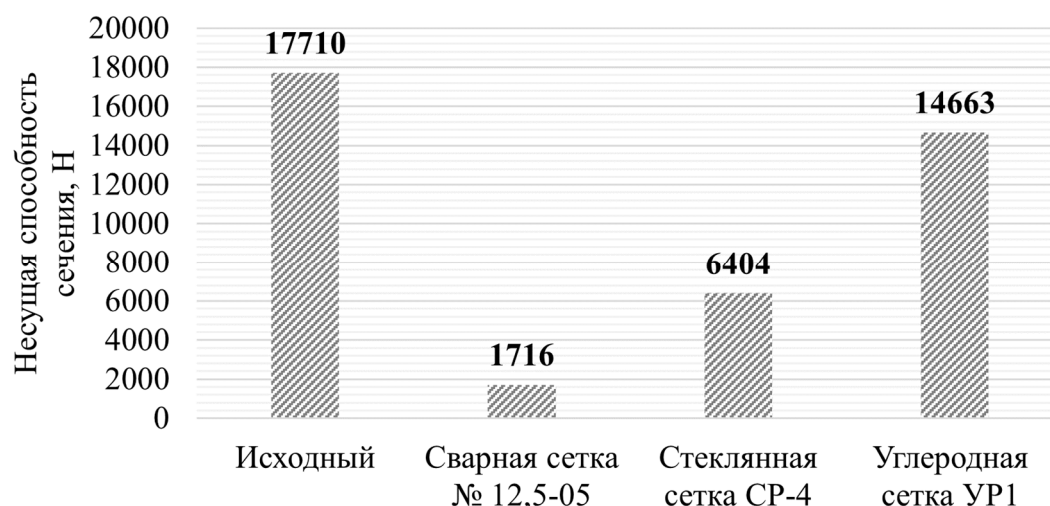
Рис. 4. Несущая способность сечения складки под действием постоянных и длительных нагрузок при расчете по первой группе предельных состояний с различными комбинациями армирования при постоянном коэффициенте армирования сетками \mu_m=0,0015
