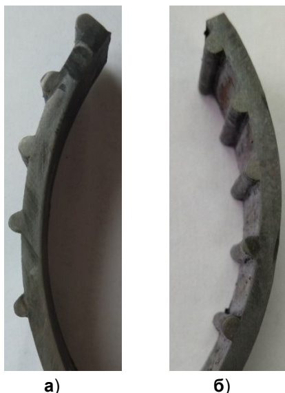
Рис. 4. Образцы единичных наплавляемых слоёв: а – на выпуклой поверхности; б – на вогнутой поверхности
