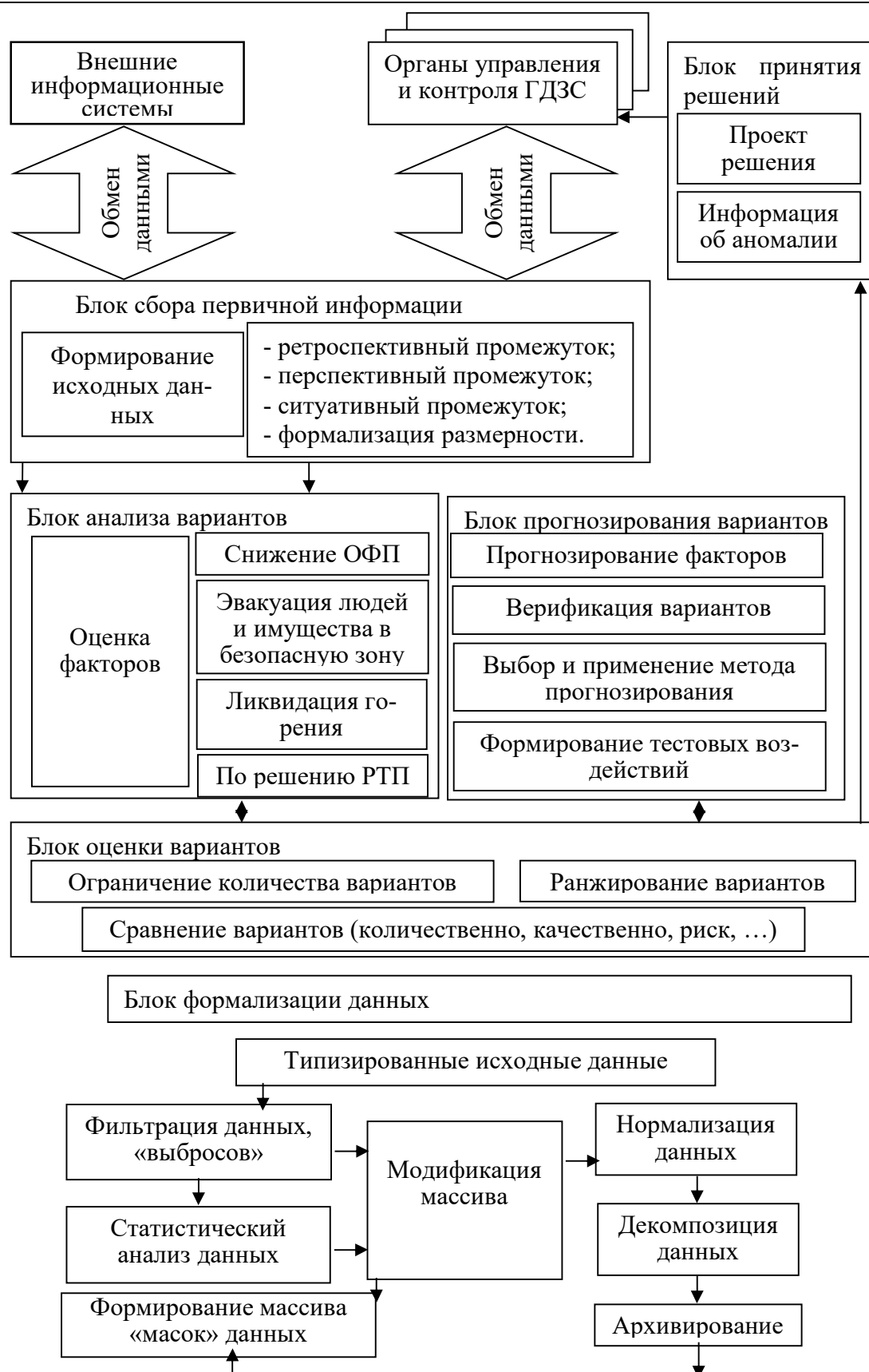
Рис. 3. Структурно-функциональная схема информационно-аналитической системы поддержки принятия решений при управлении звеньями ГДЗС
