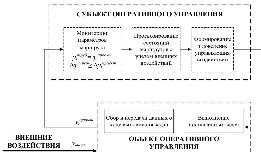
Рис. 2. Обобщенная схема цикла оперативного управления маршрутизацией автомобиля в городской агломерации
