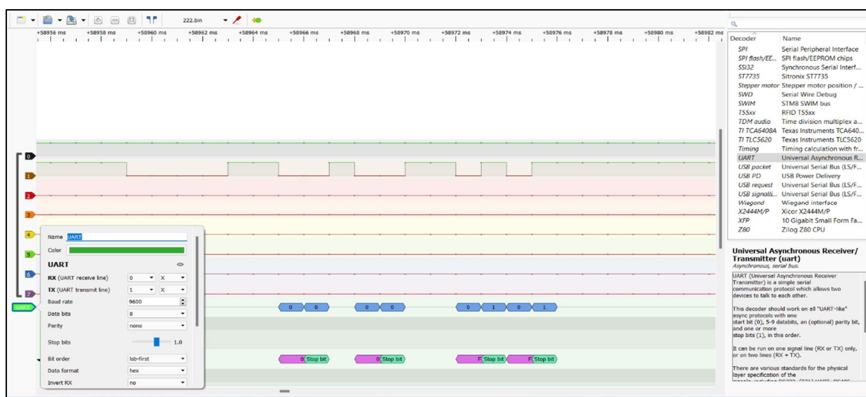
Рис. 4. Снимок выборки, декодированной как UART на скорости 9600 бод
