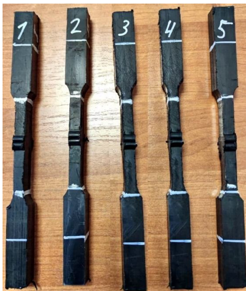
Рис. 3. Технологические образцы с маркировкой, готовые к испытаниям
