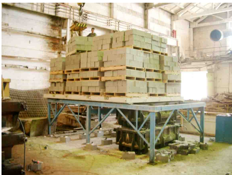
Рис.1. Плита нагружена до уровня 1,64 контрольной нагрузки
