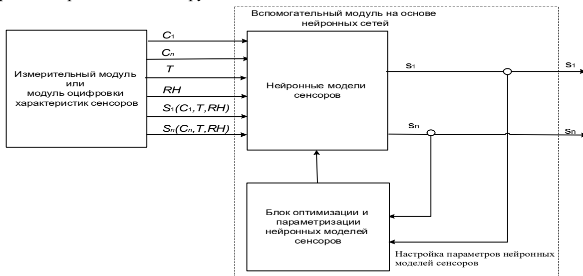
Рис. 1. Вспомогательный модуль на основе нейронных сетей: Cn — концентрации газов; T — температура; RH — относительная влажность воздуха; S — выходной сигнал сенсора
