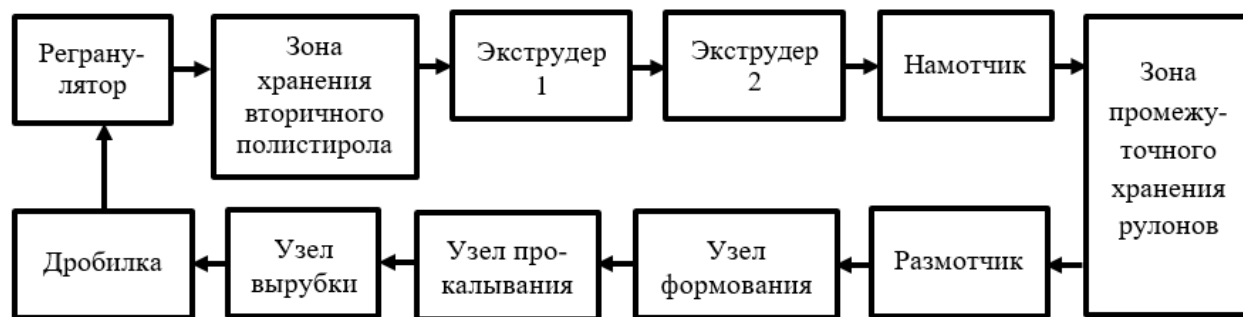
Рис. 1. Схема цикла производства упаковок из вспененного полистирола на предприятии
