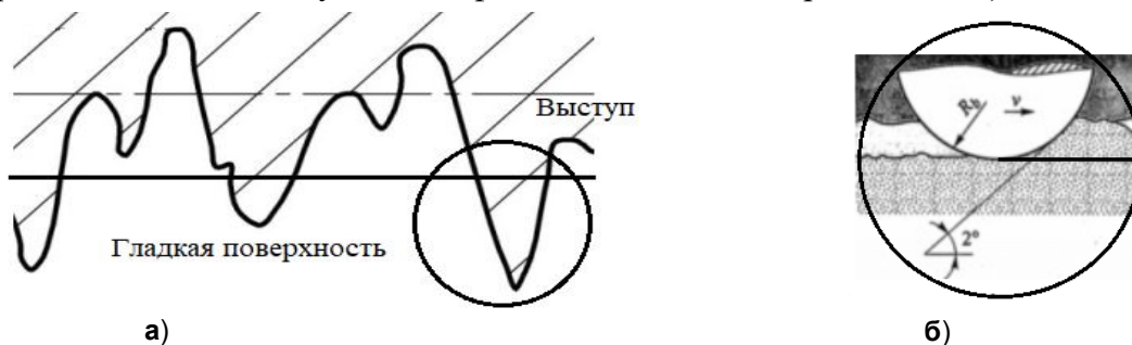
Рис. 2. Типы моделей контактного взаимодействия: а – первого типа; б – второго типа
