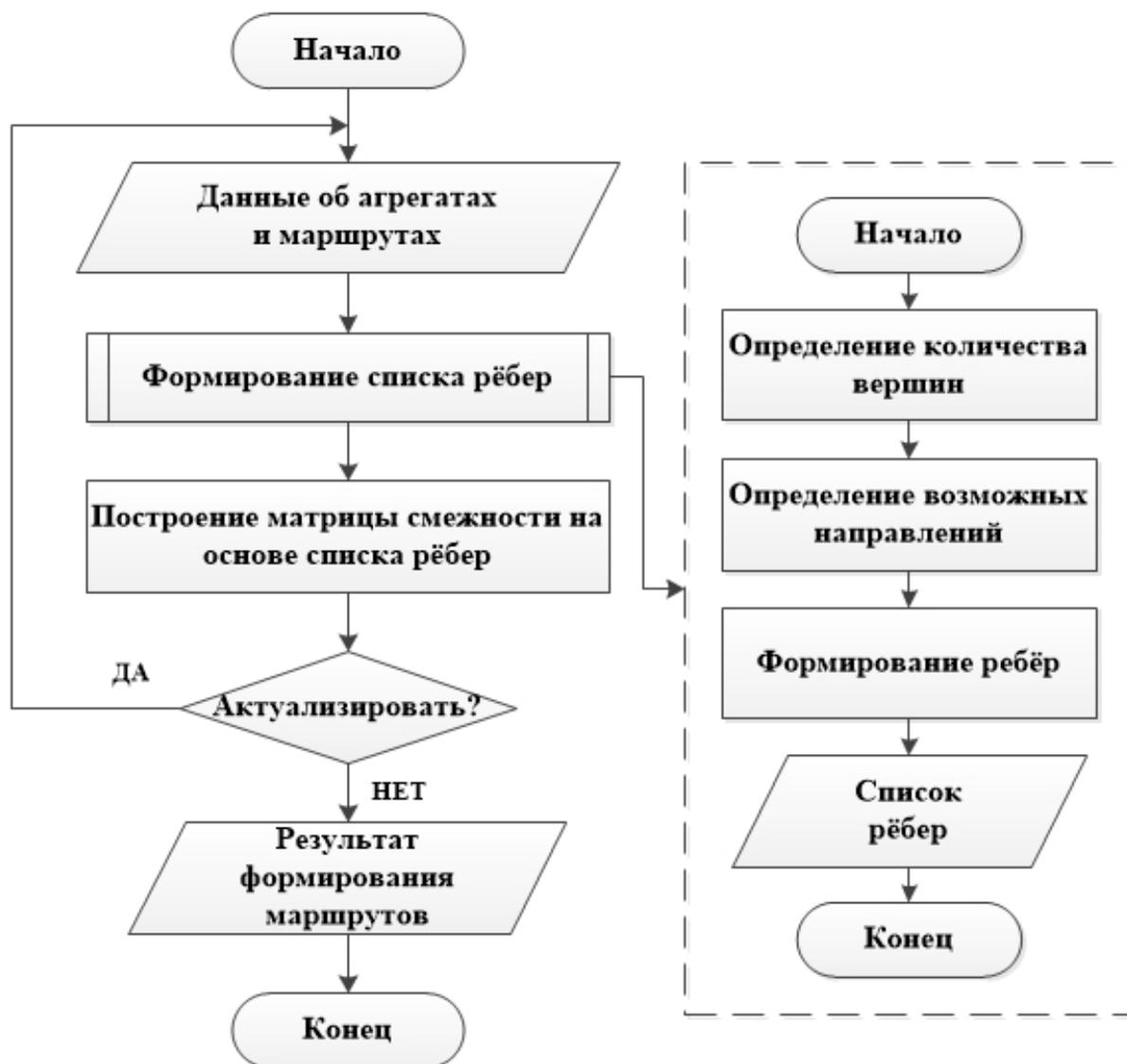
Рис. 2. Алгоритм формирования возможных маршрутов перемещения стальной в сталеплавильном производстве
