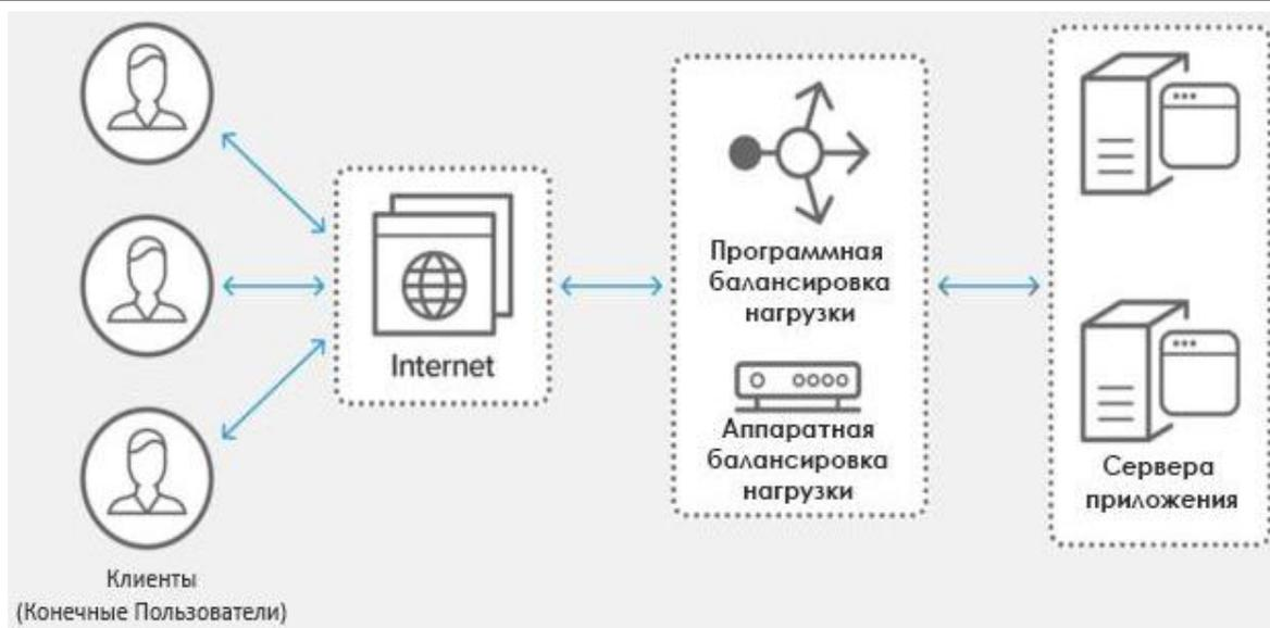
**Рис. 1.** Схема передача данных с учетом балансировки нагрузки в сети
