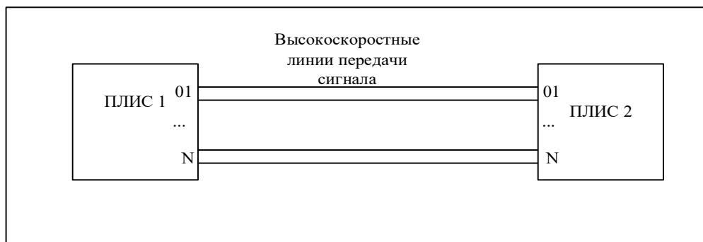
Рис. 1. Структурная схема расположения исследуемых высокочастотных линий передачи сигнала
