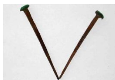
Рис. 7. Для крепления досок обшивки использовались кованые гвозди
