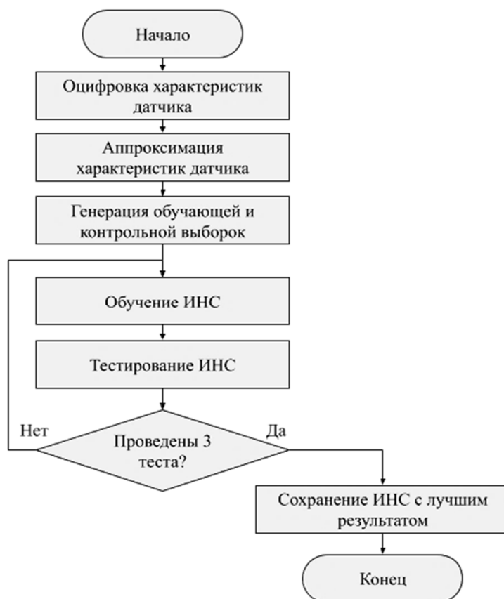
Рис. 2. Алгоритм создания нейронной модели датчика
