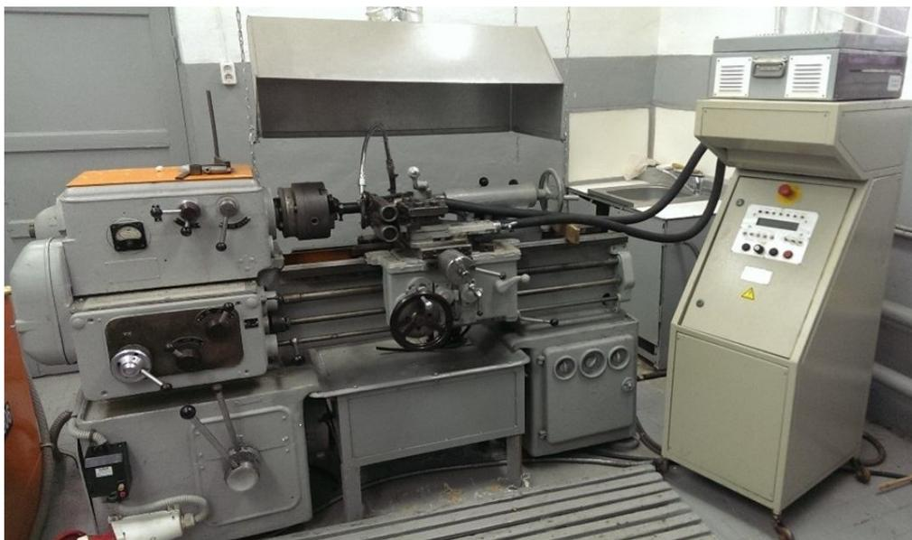
Рис. 3. Установка для электромеханической обработки
