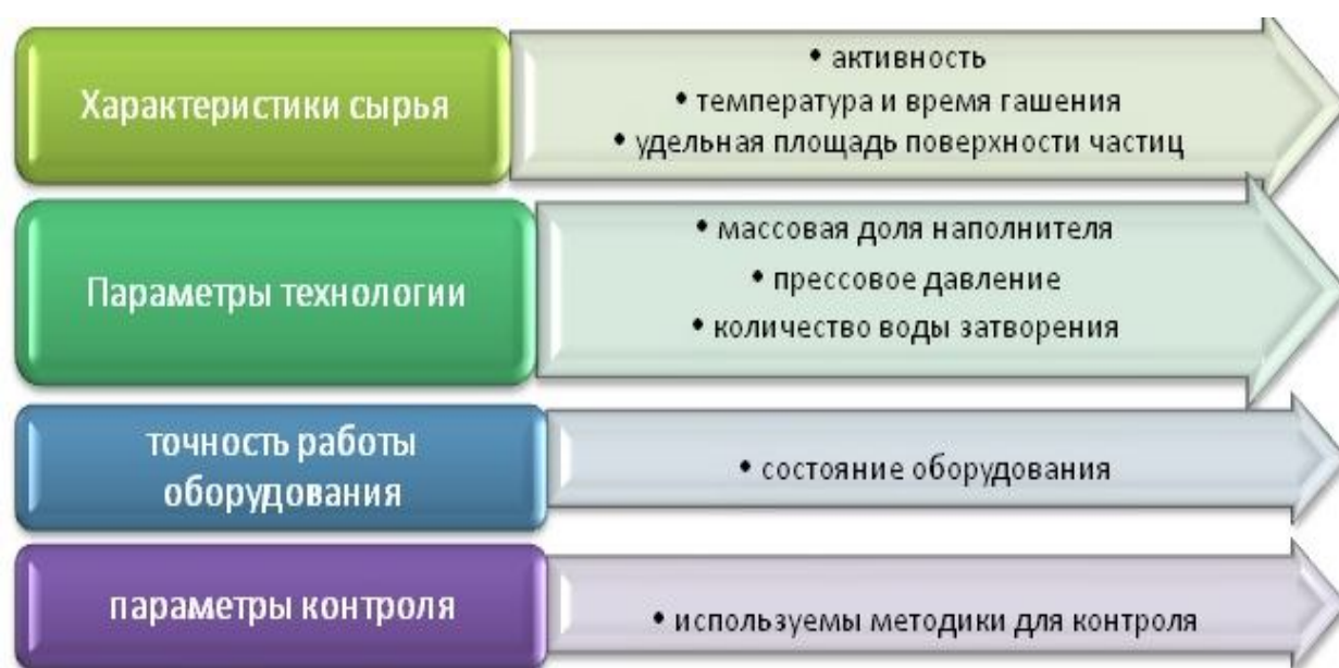
Рис. 1. Критические точки и переделы производства изделий на основе контактно-конденсационного твердения
