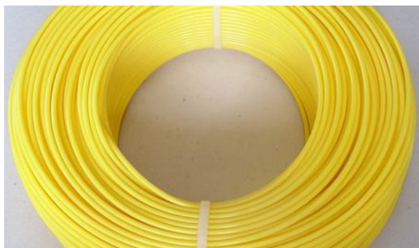
Рис. 4. Нить ABS пластика, используемая в исследованиях
