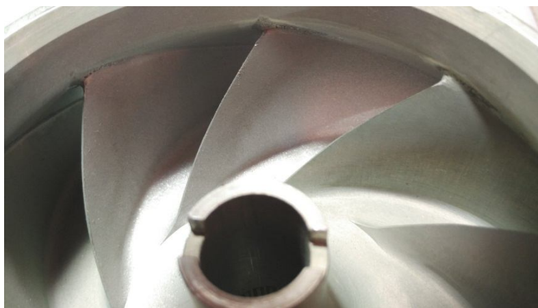
Рис. 7. Рабочее колесо ТНА, послужившее прототипом для создания формы экспериментального ЭИ
