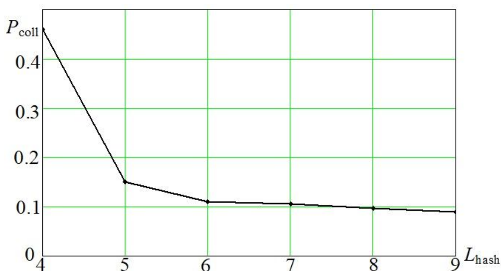
Рис. 4. Зависимость вероятности возникновения коллизии P_{\text{coll}} от длины поля хеша L_{\text{hash}} при длине цепочки l_{\text{cain}} = 15
