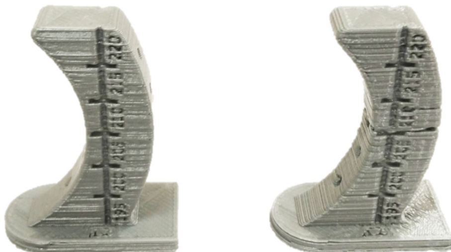
Рис. 5. Экспериментальный образец для определения коэффициента термоусадки, полученный при толщине нити: а – 0,4 мм; б – 0,8 мм
