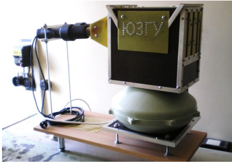
Рис. 1. Схема экспериментальной установки: 1 – корпус; 2 – патрубок для входа греющей среды; 3 – строительный фен; 4 – осевой вентилятор; 5 – подставка под вентилятор; 6 – блок LED-подсветки
