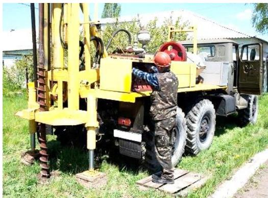
Рис. 4. Буровая установка УРБ 2А2
