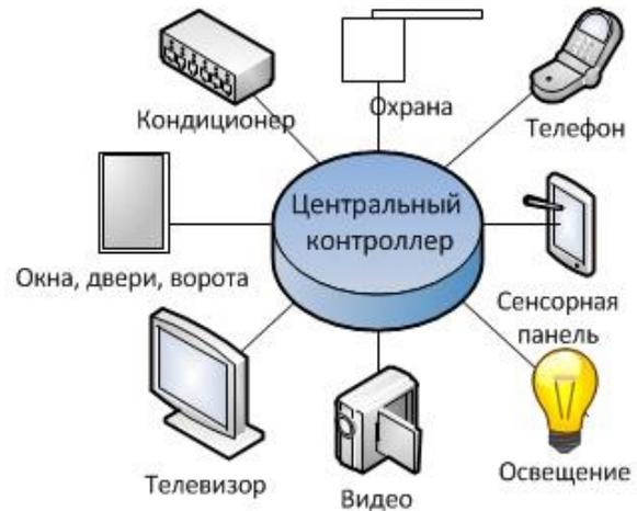
Рис. 1. Схема системы «Умный дом»
