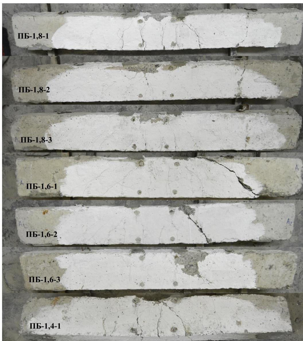
Рис. 2. Характер трещинообразования и разрушения образцов перемычек (масштаб изменен)
