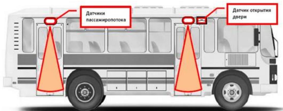
Рис. 1. Установка датчиков пассажиропотока в салоне автобуса
