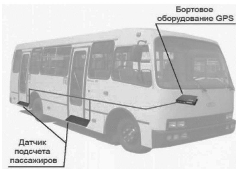
Рис. 2. Схема расположения датчиков пассажиропотока типа платформа в салоне автомобиля
