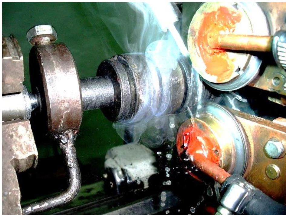
Рис. 4. Упрочнение при ЭМО
