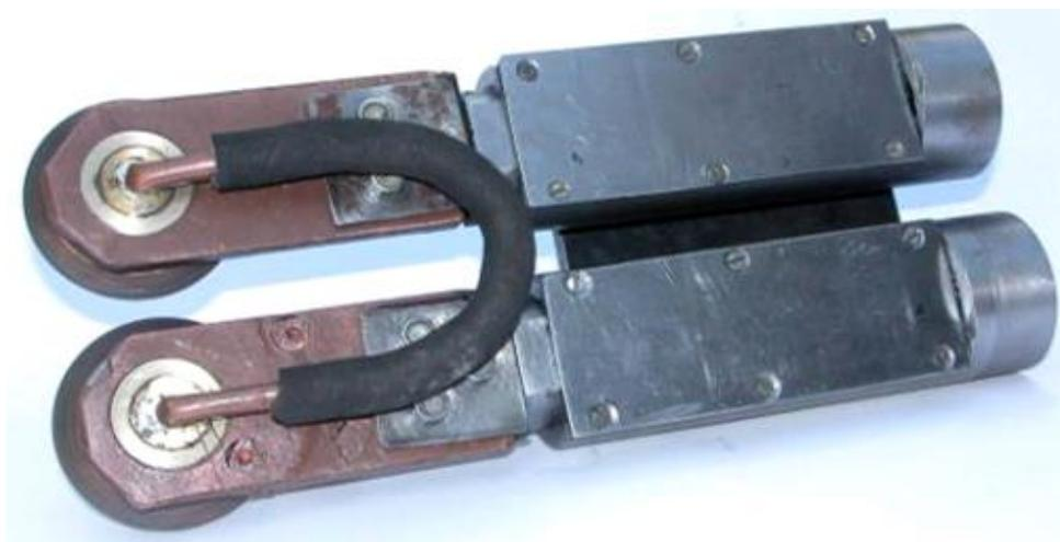
Рис. 2. Инструментальная оснастка для электромеханической обработки
