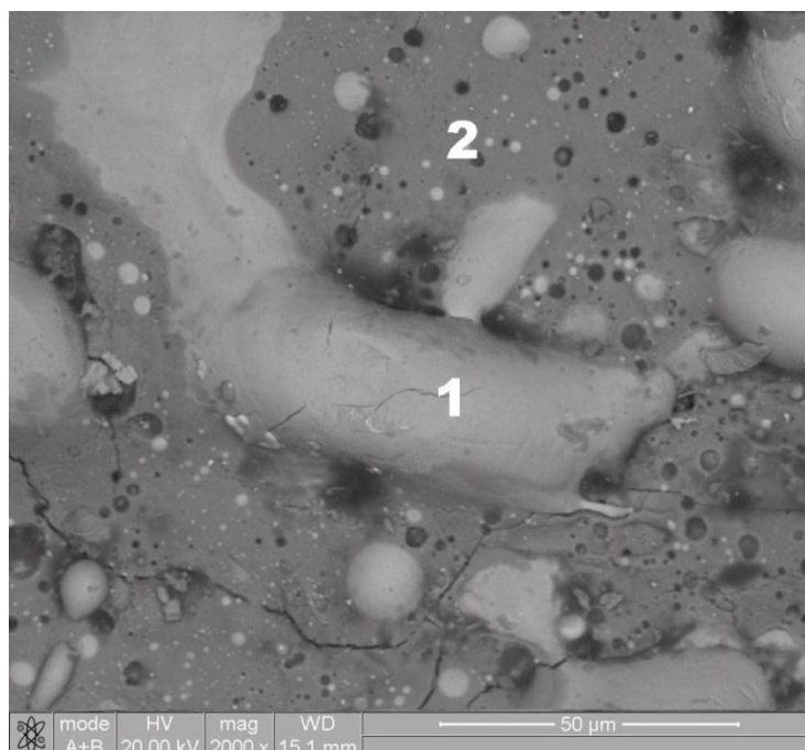
Рис. 1. Снимок с РЭМ поверхности образца с покрытием (режим обратно-рассеянных электронов) при разрешающей способности 2000 с указанием точек проведения РСМА
