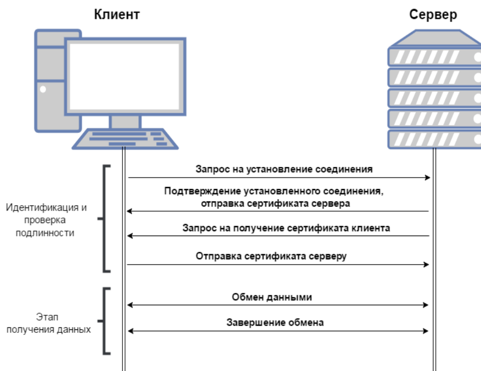
Рис. 1. Схема работы протокола рукопожатия в приложении
