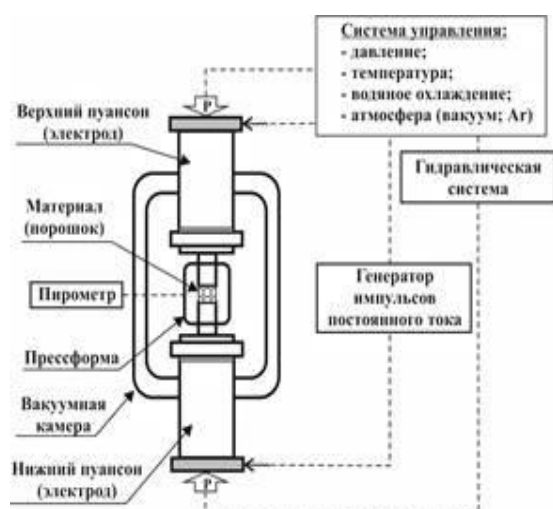
Рис. 1. Принципиальная схема SPS синтеза
