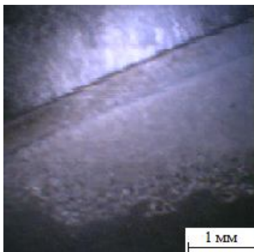
Рис. 4. Изображение стенки цилиндра двигателя, полученное с помощью технического эндоскопа
