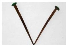
**Рис. 7.** Для крепления досок обшивки использовались кованые гвозди
