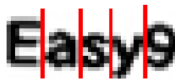
Рис.2. Пример работы алгоритма разбиения слова на символы с использованием фиксированного шага
