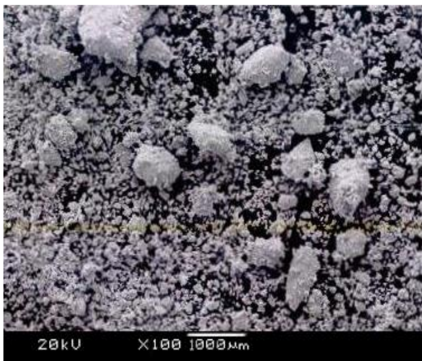
Рис. 1. Агломераты в порошке UO_2 (увеличение 100×)
