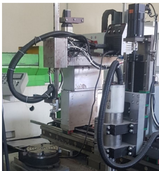
Рис. 2. Установка для послойного нанесения порошков
