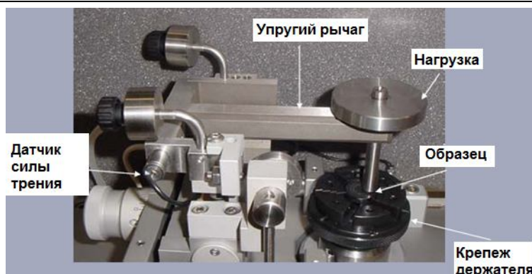
Рис. 4. Схема-внешний вид автоматизированной машины трения (Tribometer, CSM Instruments, Швейцария) [28]
