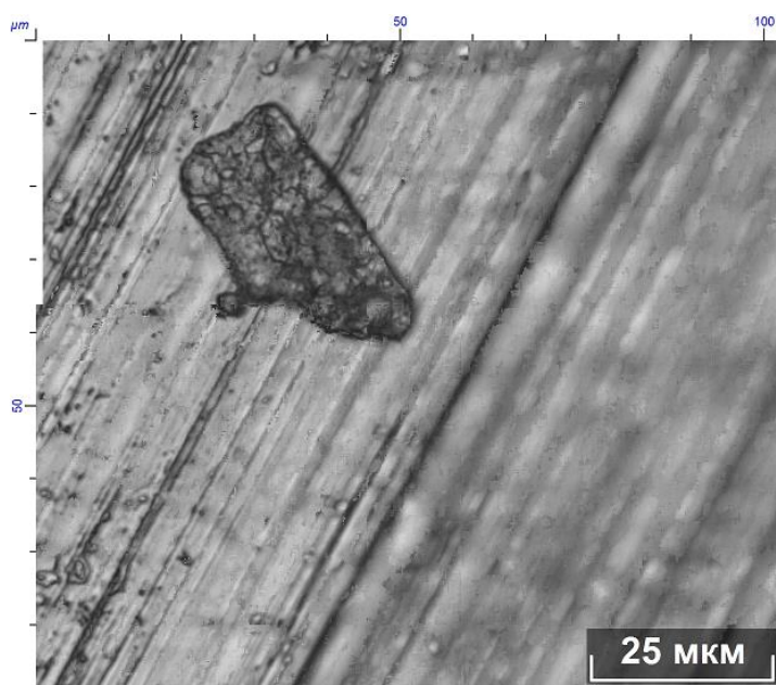
Рис.5. Локальная плёнка после трения в среде смазки с серпентинитом (увеличение в 1000 раз)
