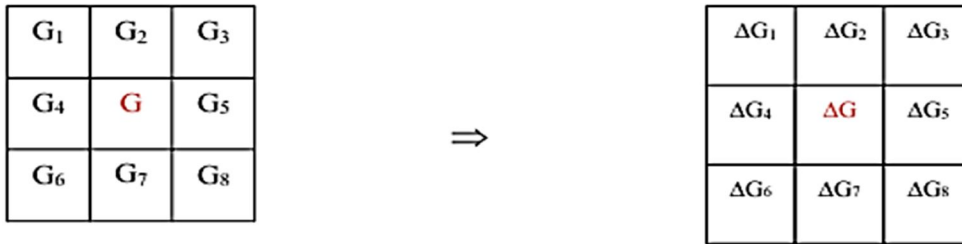
Рис. 2. Вычисление разности градиентов смежных ячеек
