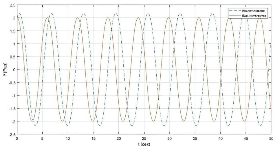
**Рис. 2.** Сравнение траектории движения материальной точки плоского маятника, полученной при моделировании с использованием вариационного интегратора, с аналитической траекторией
