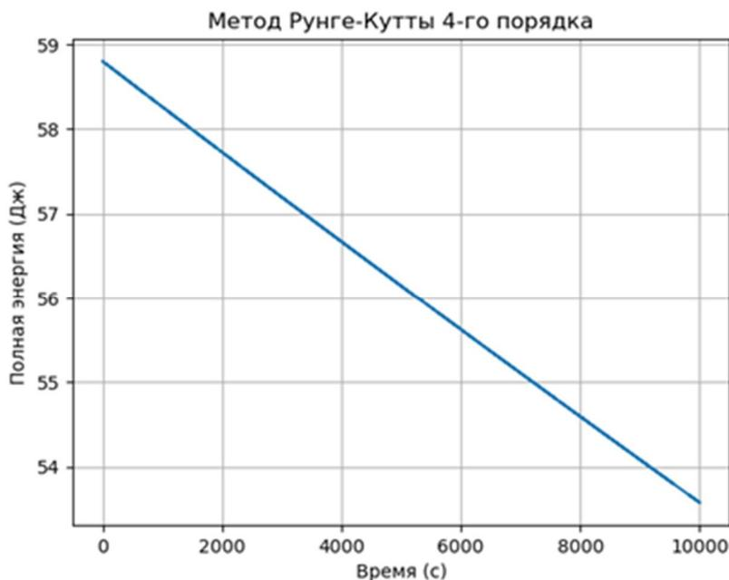
**Рис. 1.** Энергетическое поведение модели динамики плоского маятника с применением метода Рунге-Кутты четвертого порядка
