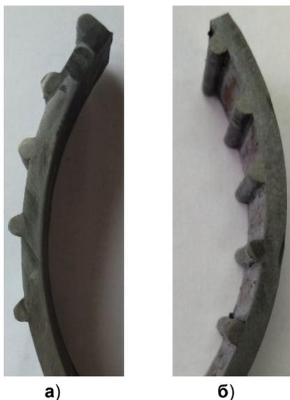
**Рис. 4.** Образцы единичных наплавленных слоёв: **а** – на выпуклой поверхности; **б** – на вогнутой поверхности
