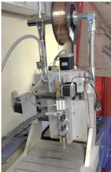
**Рис. 2.** Экспериментальный стенд для аддитивного формообразования
