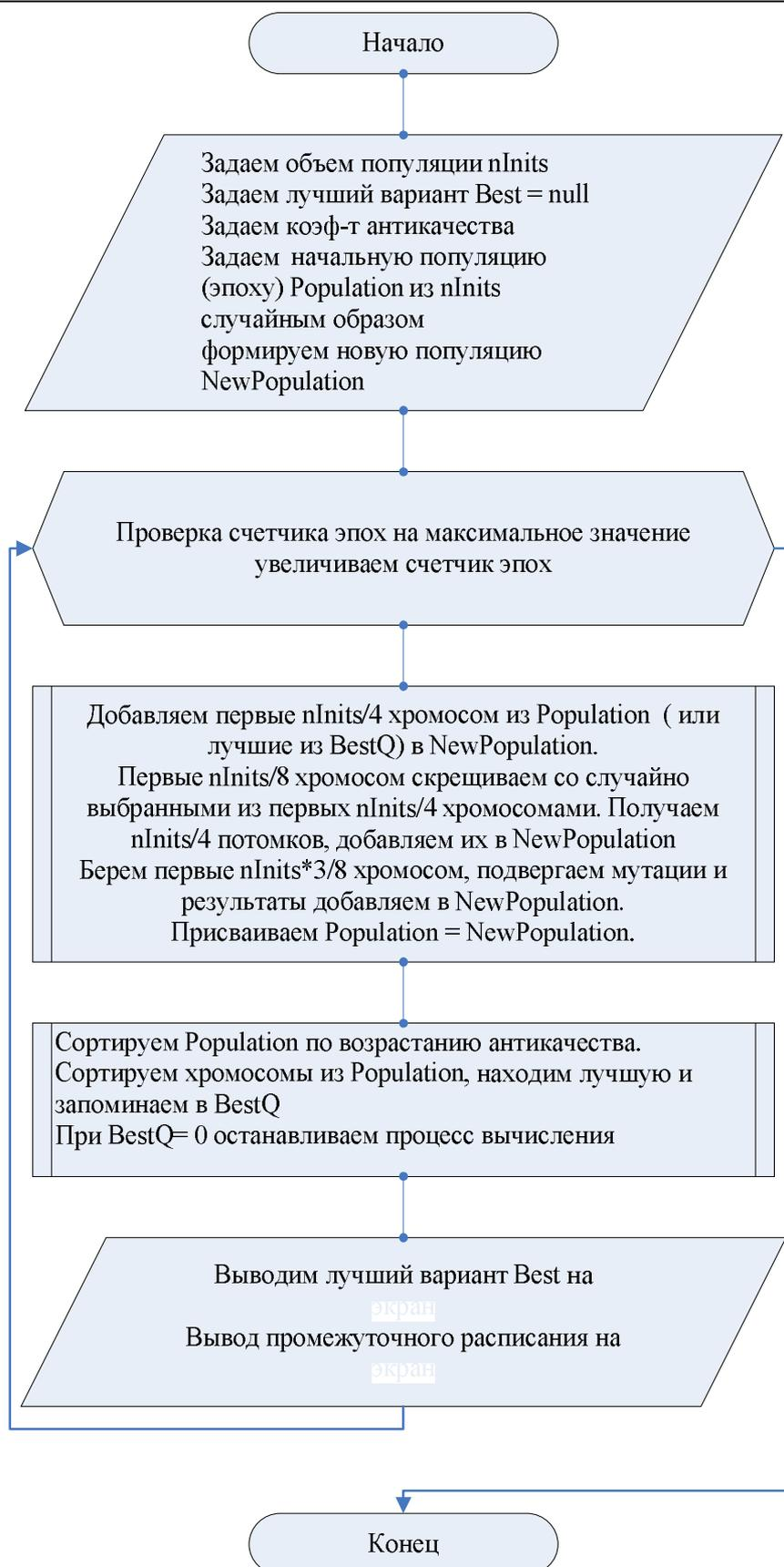
**Рис. 1.** Алгоритм составления расписания на генетическом алгоритме
