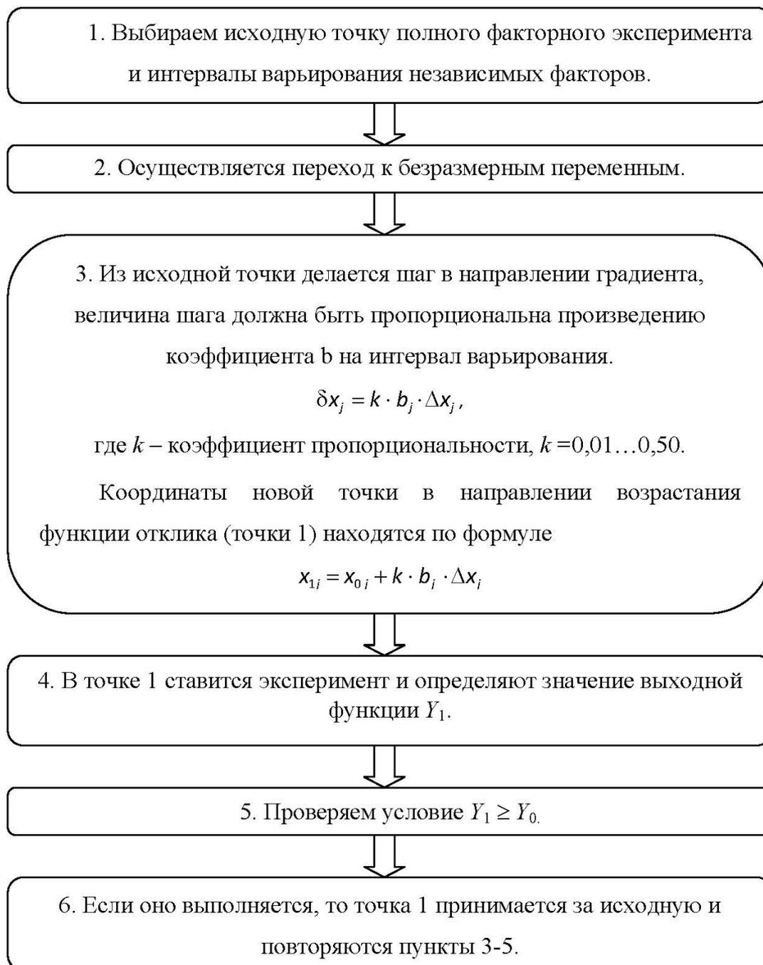
Рис. 7. Блок-схема расчета крутого восхождения
