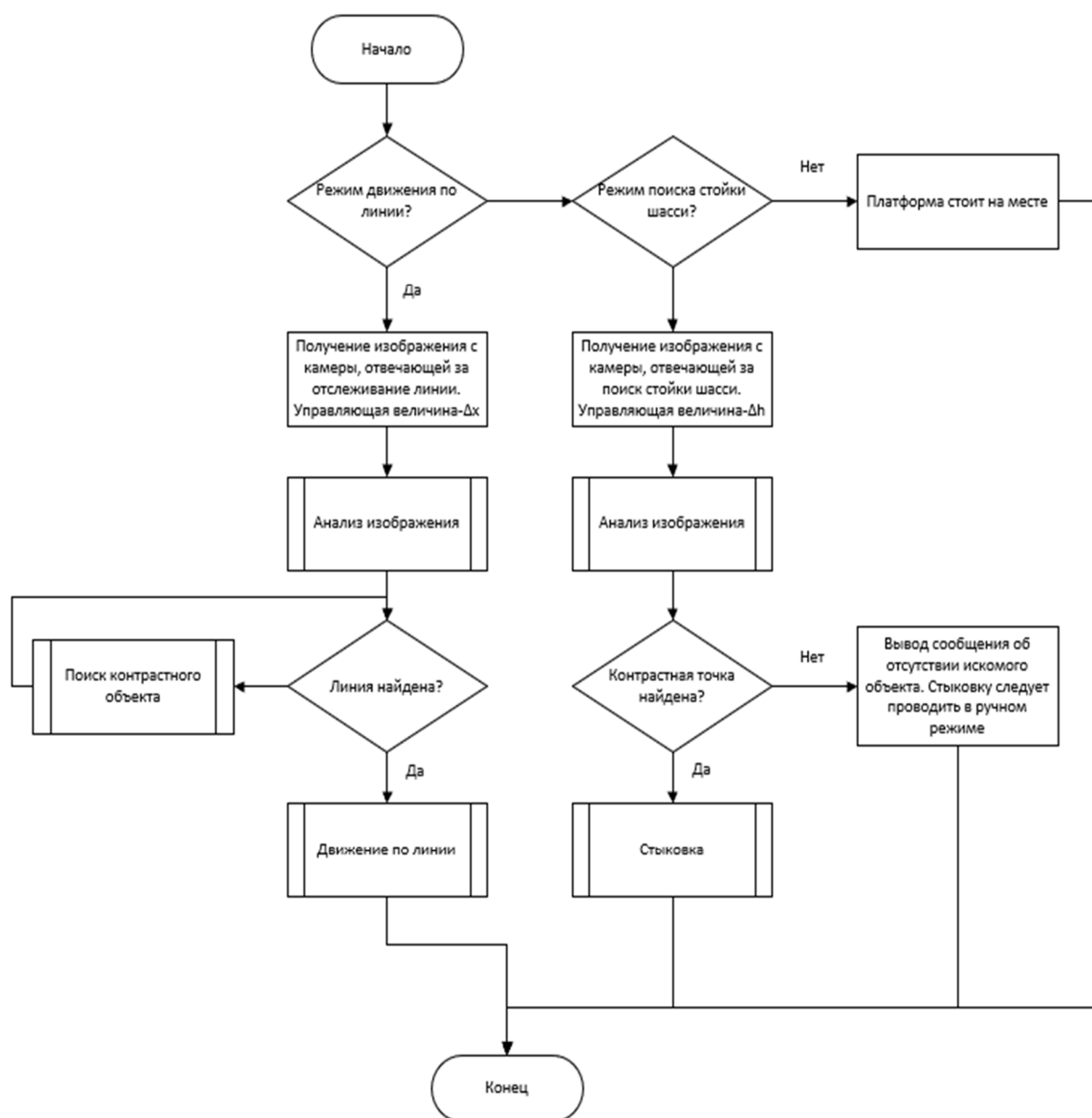
Рис. 4. Блок-схема логического регулятора САУ
