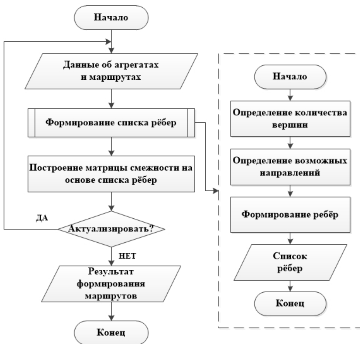
Рис. 2. Алгоритм формирования возможных маршрутов перемещения стальной
