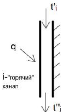
Рис. 1. Принципиальная схема передачи тепла для крайних каналов
