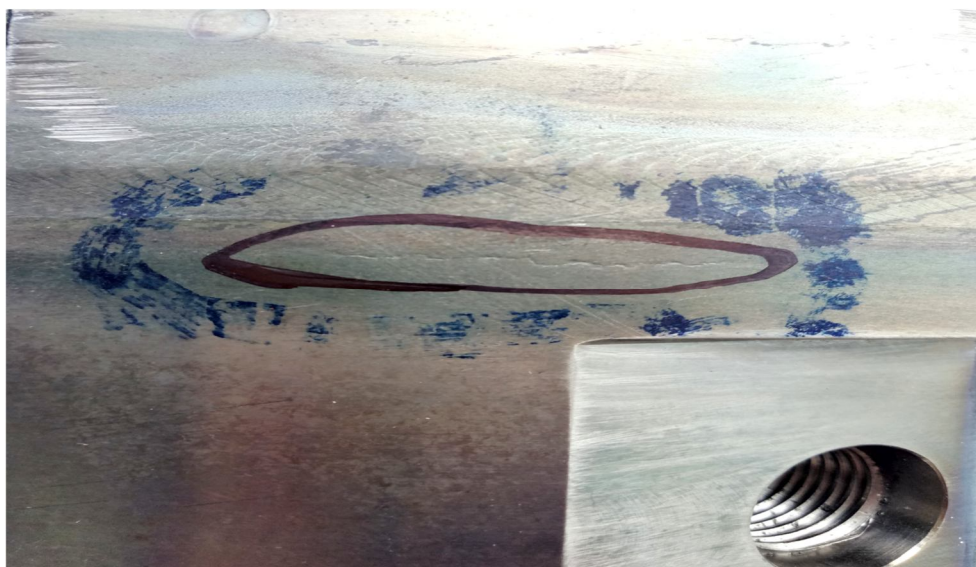
Рис. 1. Трещина, возникшая при гидравлических испытаниях в околошовной зоне
