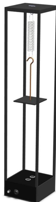
**Рис. 4.** Прототип экспериментальной установки для измерения жесткости пружин и исследования простых гармонических колебаний
