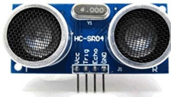
Рис. 6. Ультразвуковой датчик HC-SR04
