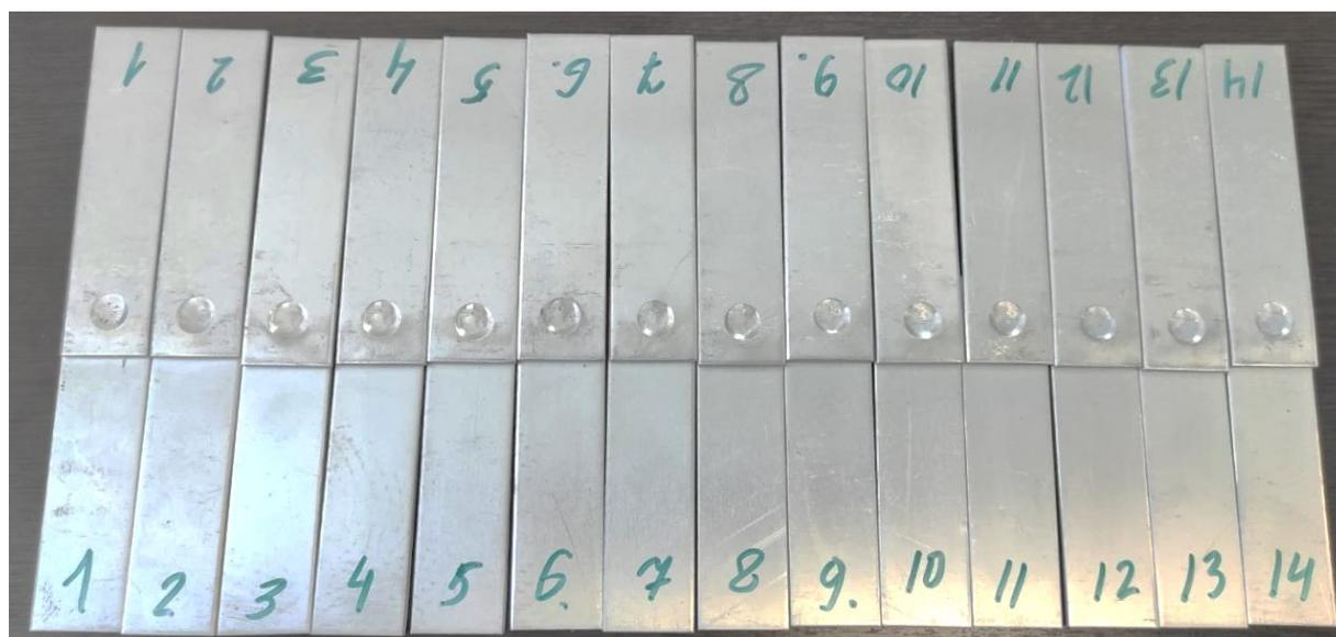
Рис. 1. Сварные образцы для испытаний
